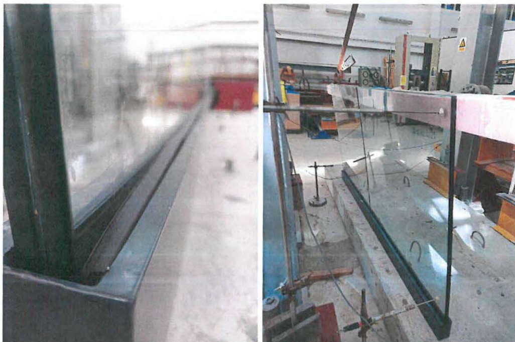
FOTOGRAFIJE 5 i 6 Ponašanje dijelova ogradnog sustava za vrijeme opterećenja od 3,80 kN
