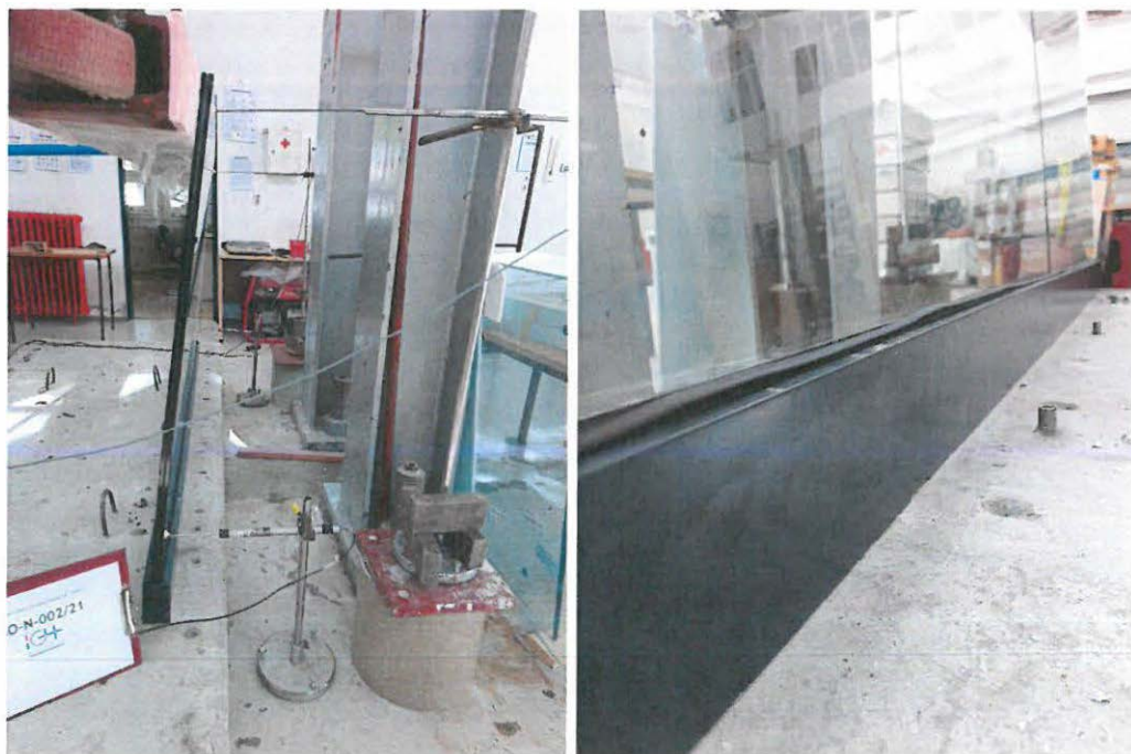
FOTOGRAFIJE 7 i 8 Dijelovi ogradnog sustava za vrijeme i nakon opterećenja od 5,80 kN
