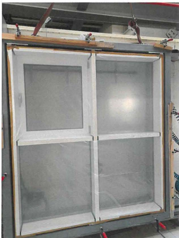
Slika 7: fasadni element tijekom „slijepa probe“ sa zrakonepropusnom membranom na vanjskoj strani uzorka.
